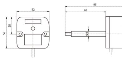
Il sensore termico controlla la temperatura in due zone: ambiente e condotta. Il servomotore aprirà quando la temperatura raggiungerà i 72°C in una delle due zone. E' presente un pulsante di test sul sensore.
